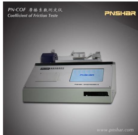
**工作原理：**两试验表面平放在一起，在一定的接触压力下，使两表面相对移动，记录所需的压力，计算静摩擦系数和动摩擦系数。
